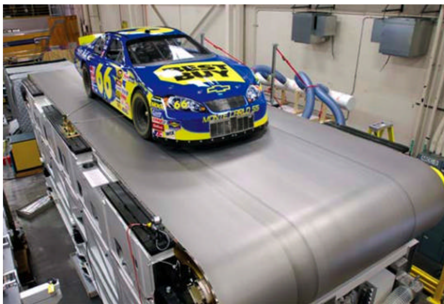
Figura 26: Esteira da Windshear Inc. para o túnel de vento de escala real em fabricação
